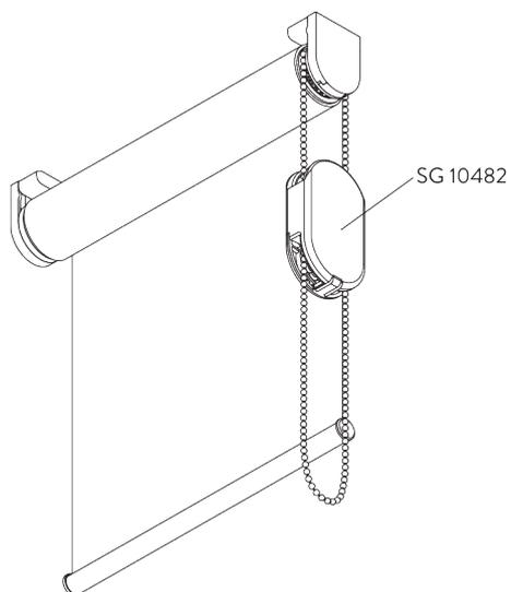
チャイルドセーフティデバイス SG 10482は、チェーンを引く力が6 kgを超えると分離します。
