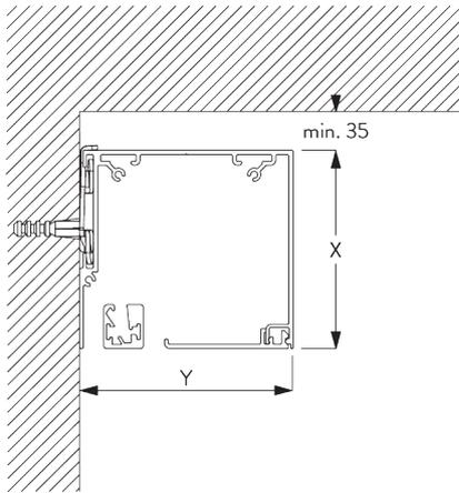
**ボックスS & クランプ SG 3044 / ボックスL & クランプ SG 11180**
